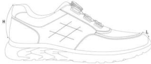
图3 成品尺寸测量部位示意图
